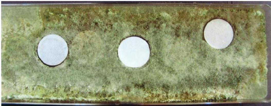
試験菌 (黄色背景: 一般建築物から検出される 57 菌 青色背景: JIS 試験規格の 5 菌)
